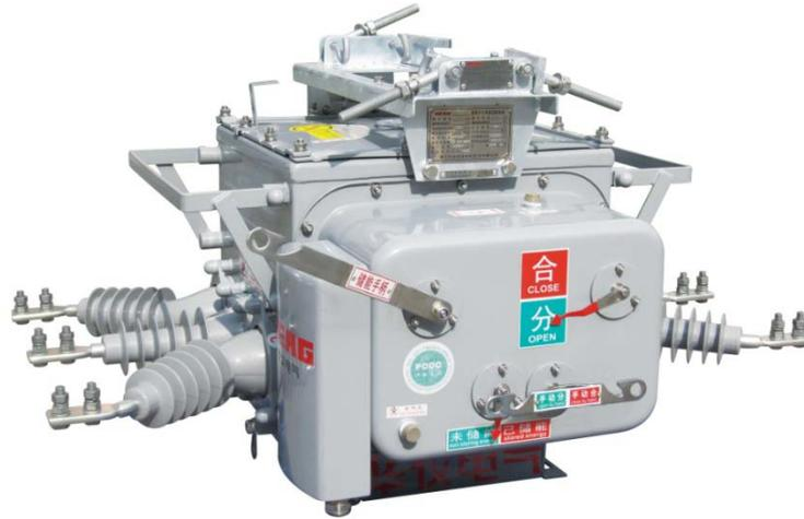
ZW20A-12/T630(1000)-20(25)型户外高压交流真空断路器(以下简称断路器)为额定电压 12kV，三相交流 50Hz 的户外配电设备。ZW20A-12 型断路器是一种免维护产品，优良的电气和机械性能，使 ZW20A-12 型户外柱上真空断路器得到广泛的应用。主要用于开断、关合 10kV 电力系统的负荷电流及短路电流,适用于变电站及工矿企业配电系统中作保护和控制之用，更适用于电网频繁操作的场所。本产品与控制器配套，能满足配电自动化系统要求。已通过 PCCC 认证，是柱上断路器中的佳品。产品获多项国家专利，
